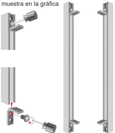
C) Ensamblar un (1) perfil lateral con el perfil superior y el perfil inferior, insertando la escuadra por la guía del perfil superior e inferior, luego ajustar la escuadra con el tornillo bristol como se muestra en la gráfica
