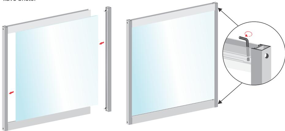
E) Insertar las rodachinas derechas e izquierdas en el perfil superior e inferior y ajustarlas con el tornillo como se muestra en la siguiente ilustración
