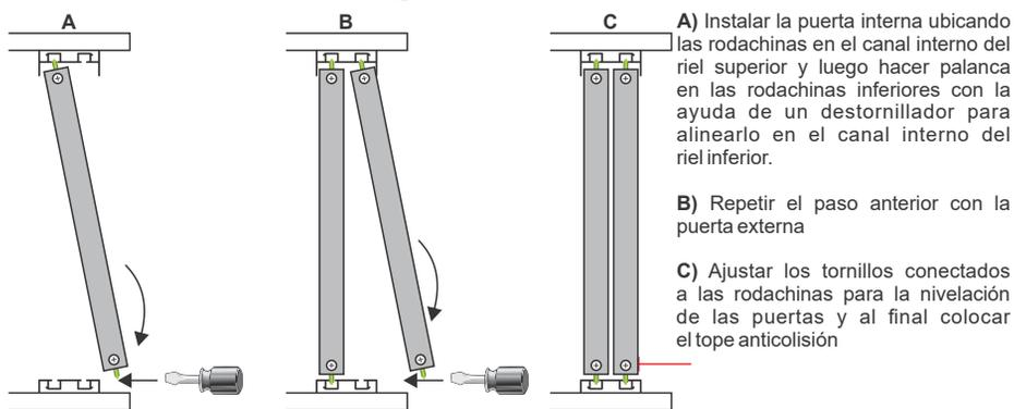
**A)** Instalar la puerta interna ubicando las rodachinas en el canal interno del riel superior y luego hacer palanca en las rodachinas inferiores con la ayuda de un destornillador para alinearlos en el canal interno del riel inferior.
