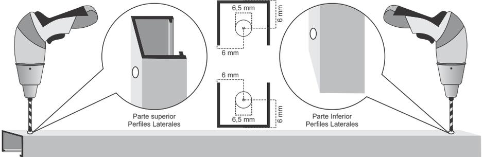
B) Colocar las escuadras en la parte inferior y superior de los perfiles laterales como se muestra en la gráfica
