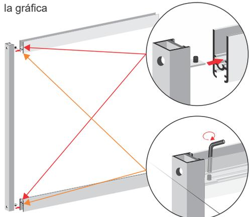
D) Insertar el vidrio o acrílico y colocar el otro perfil lateral ajustando igualmente la escuadra con la llave bristol
