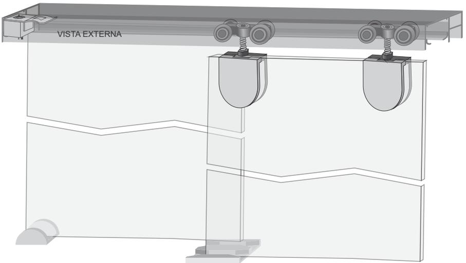
C) Para regular la altura de la puerta deba ajustar el tornillo de la rodachina con la llave pequeña
